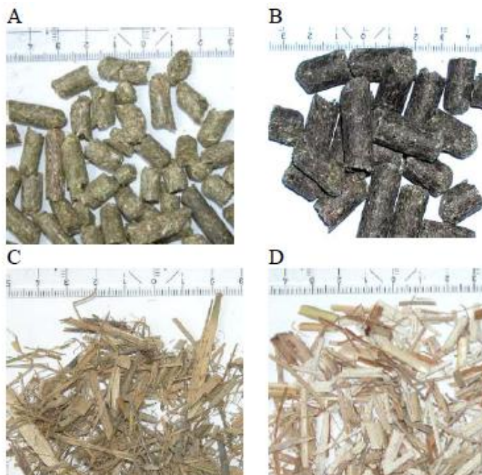
A – гранули з проса прутopodobного, B – гранули з артишока іспанського, C – подрібнений арундо тростинний, D – подрібнений міскантус
