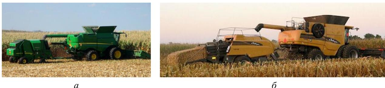
**Рис. 26.** Однопроходная система: а – Hillco для тюкования в рулоны; б – AGCO Challenger для формирования прямоугольных тюков
