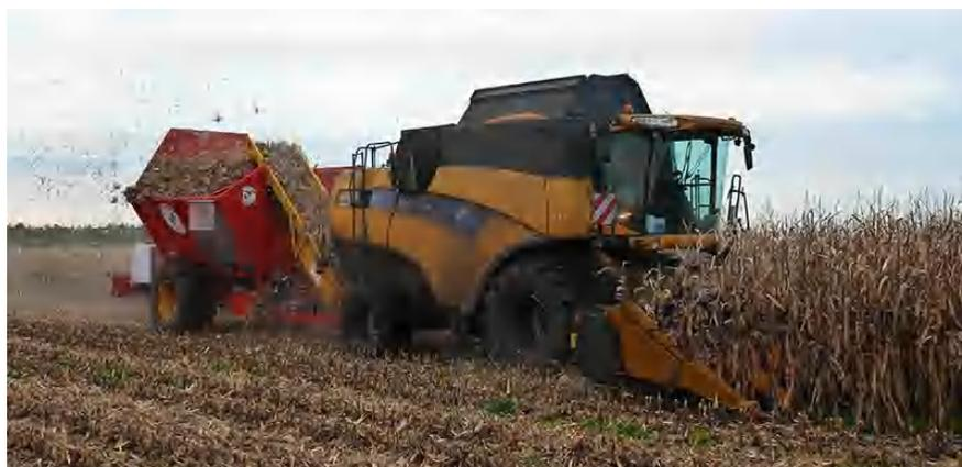
**Рис. 27.** Зерноуборочный комбайн с подборщиком качанов COBS HARVESTER Lafargue Bio Energy
