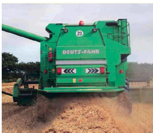
Рис. 5. Укладывание неизмельченной соломы в валки [16]
