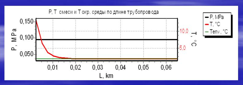
Распределение температуры и давления потока по длине трубопровода
