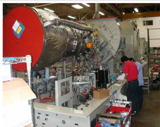
Рисунок 4-7. Подача двух видов топлива в широком диапазоне чисел Воббе в «солнечную» газовую турбину 13
