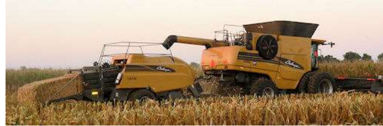
Однопрохідна система AGCO Challenge для формування прямокутних тюків
