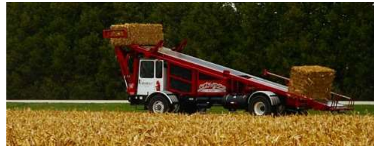
Машина Stinger Stacker 6500 для швидкого збирання тюків по полю
