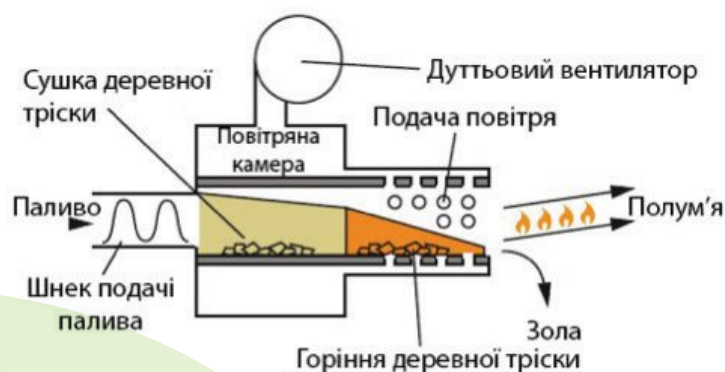
Рисунок 4. Котел з нерухомою колосниковою решіткою [2]
