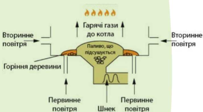
Рисунок 5. Котел з нижньою подачею палива [2]
