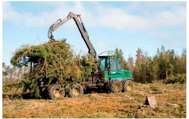
Перевезення порубкових решток форвардером
