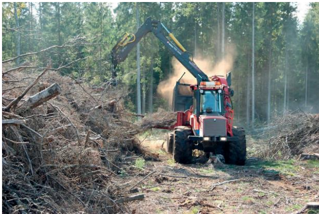
Виробництво деревної тріски з порубкових решток рубальною машиною, агрегрованою з с/г трактором
