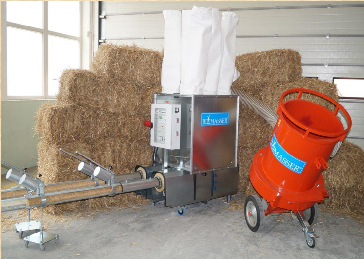
Прес BIOMASSER DUO (шнековий) з подрібнювачем TOMASSER RK (брикети Pini&Kay)
