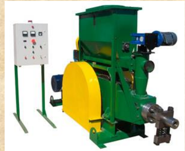
Прес ПБУ-060-400 (ударно-механічний) з бункером-дозатором (брикети NIELSEN)
