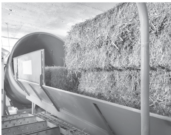
Фото 5. Виготовлення брикетів із соломи (обладнання «Biomasser»)
