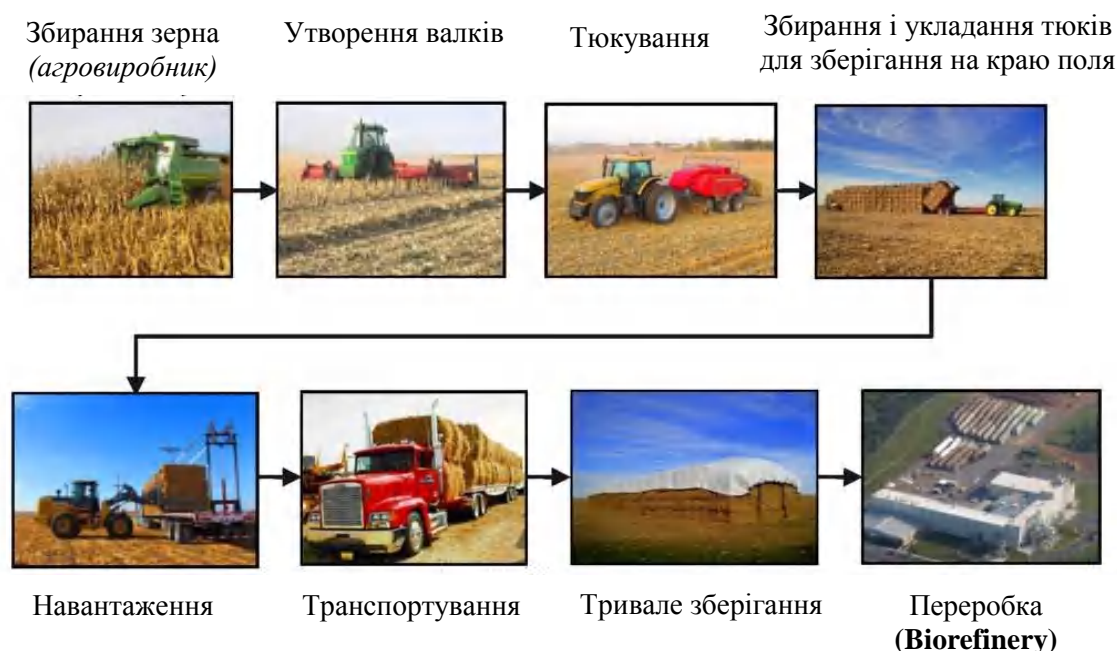
Рис. 20. Технологічна схема заготівельно-логістичної структури для ПП кукурудзи на зерно компанії DuPont [25].
