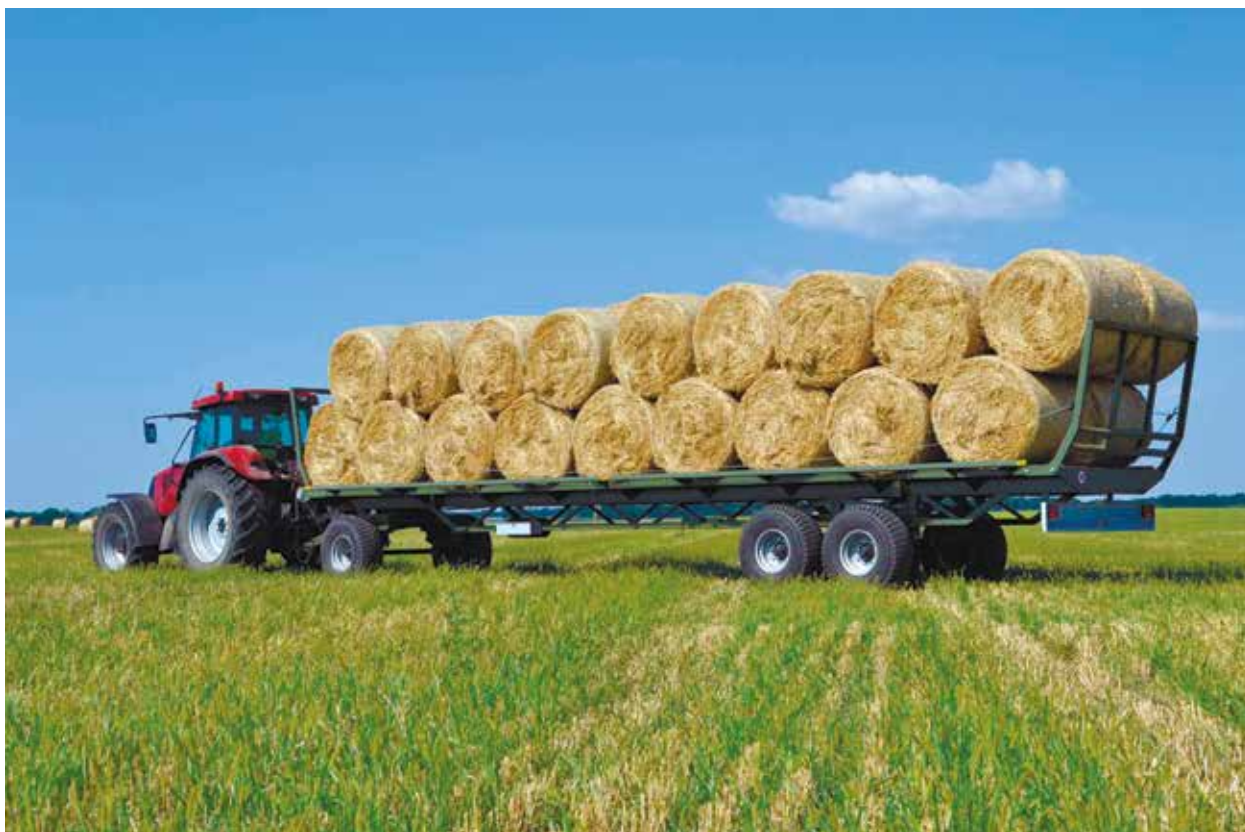
Рис. 3.20. Причіп-платформа для перевезення циліндричних тюків ПП-12/3 (виробництво ТОВ «Завод Кобзаренка», Україна)
