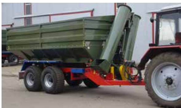
Рис. 4.28. Загальний вигляд бункера-накопичувача золи ПБН-16
