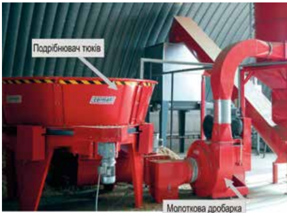
Рис. 3.31. Молоткова дробарка у зв'язці із подрібнювачем агросировини 9
