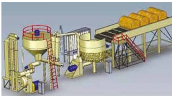
Рис. 3.37. Типова компоновка лінії для виробництва агропелет із циліндричних тюків соломи (Литва)
