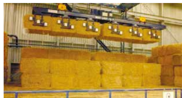
Рис. 3.19. Перевезення великих тюків соломи та розвантаження їх за допомогою кранів
