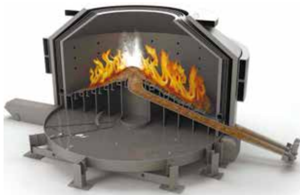
Рис. 4.11. Обертальна решітка з нижньою подачею палива
