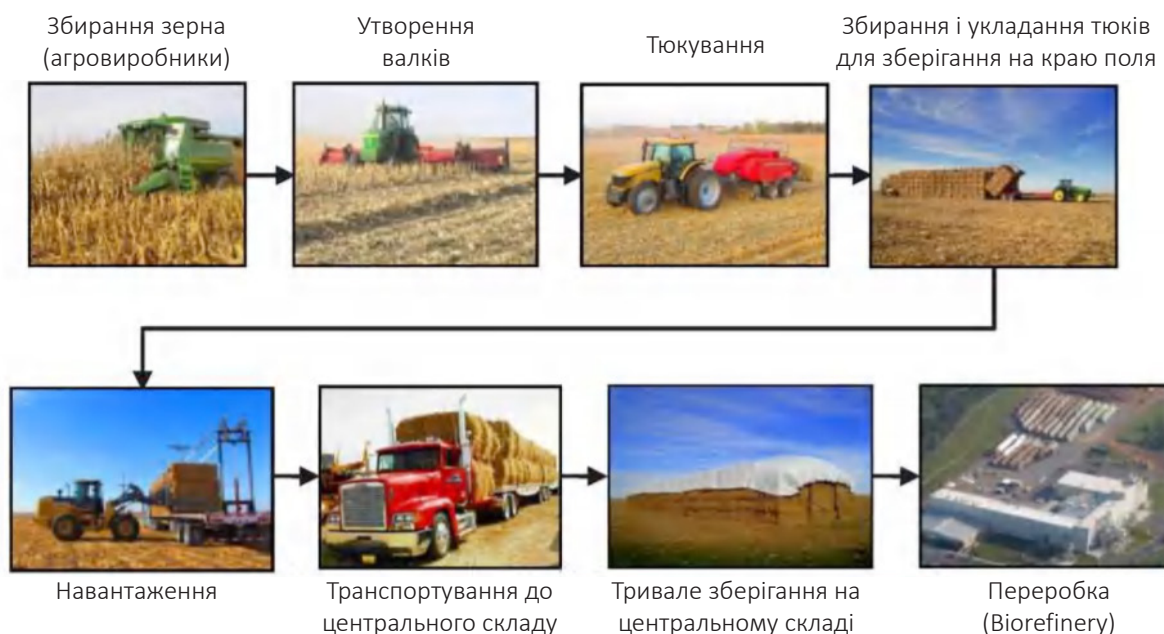
Рис. 2.3. Схема заготівельно-логістичної структури для збирання ПП кукурудзи для заводу виробництва біоетанолу із лігноцелюлозної сировини DuPont 15
