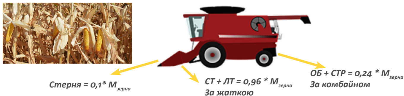
Рис. 1.6. Орієнтовні потоки рослинних решток при збиранні кукурудзи зернозбиральним комбайном
