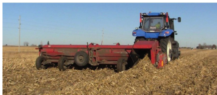
с) Трипрохідна система: комбайн + трактор з мульчувачем-валкоутворювачем + трактор з прес-підбирачем
