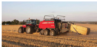
б) Двопрохідна система: комбайн з жаткою валкоутворювачем + трактор з прес-підбирачем
