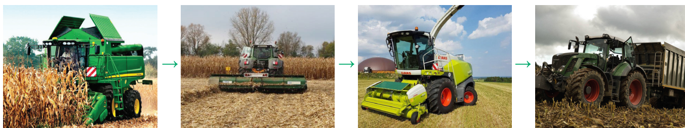
а) Система на базі кормозбирального комбайна: зернозбиральний комбайн + трактор з мульчувачем-валкоутворювачем + кормозбиральний комбайн + трактор з причепом
