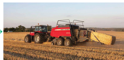
д) Багатопохідна система: комбайн + трактор з мульчувачем + трактор з граблями + трактор з прес-підбирачем
