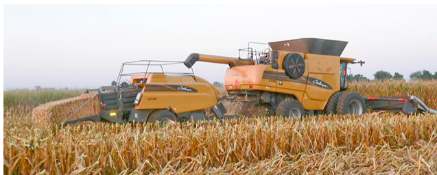
а) Однопрохідна система: комбайн з прес-підбирачем
