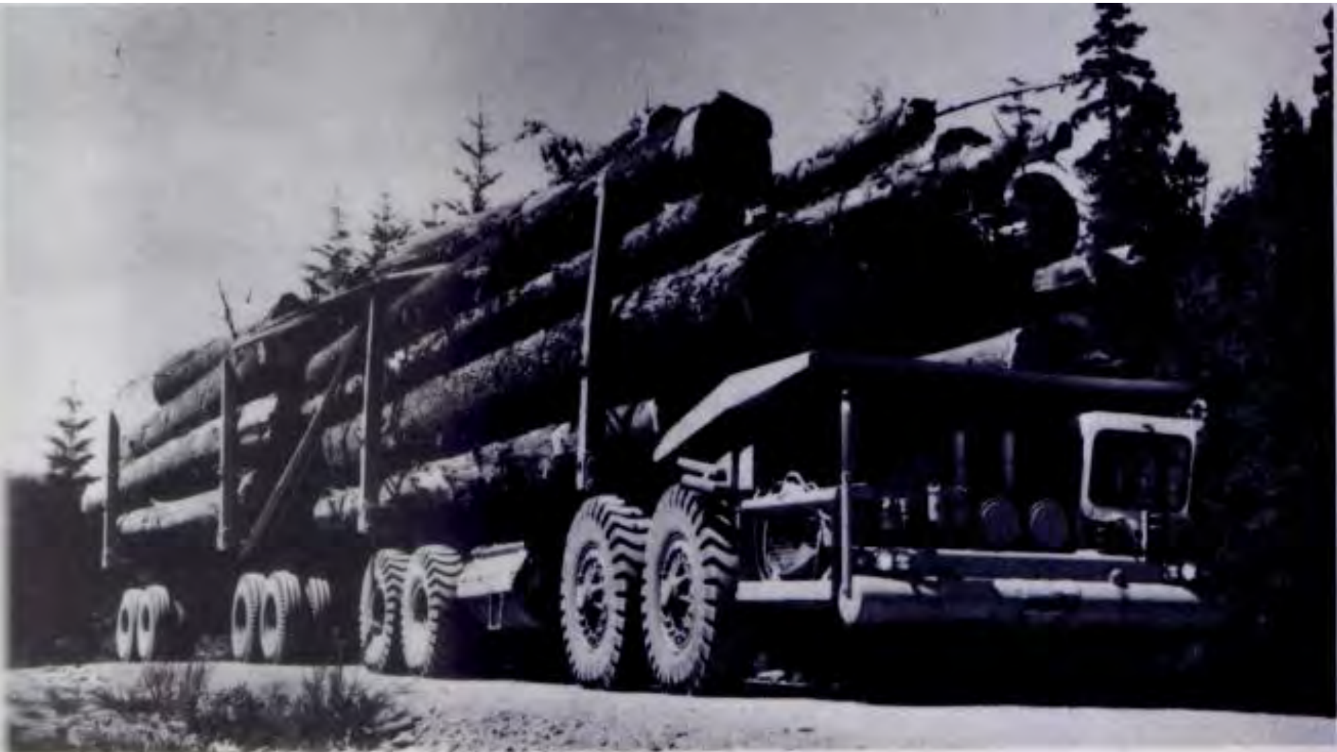
Рис. 34. Тяжелый автопоезд общей грузоподъемностью 200 т.
