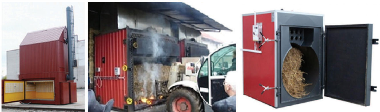
Рисунок 1 – Загальний вигляд котлів періодичного спалювання
