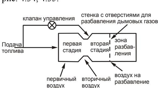
Рис. 4.34. КС по стадиям сжигания топлива.
