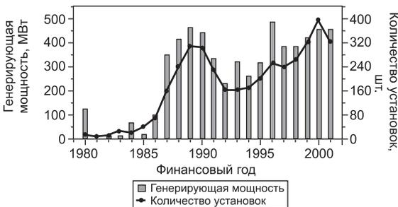
Рис. 5.44. Ежегодное введение когенерационных установок по мощности и количеству.
