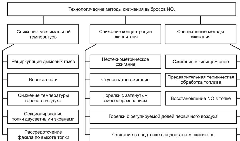
Рис. 4.13. Технологические методы снижения выбросов оксидов азота [3].
