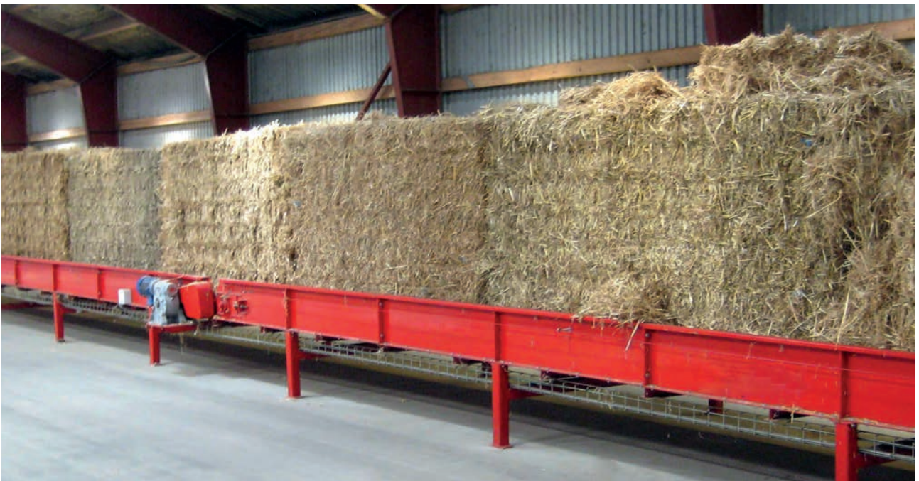
Транспортер для автоматичного завантаження тюків соломи. СВІТЛИНА Cormall A/S.
