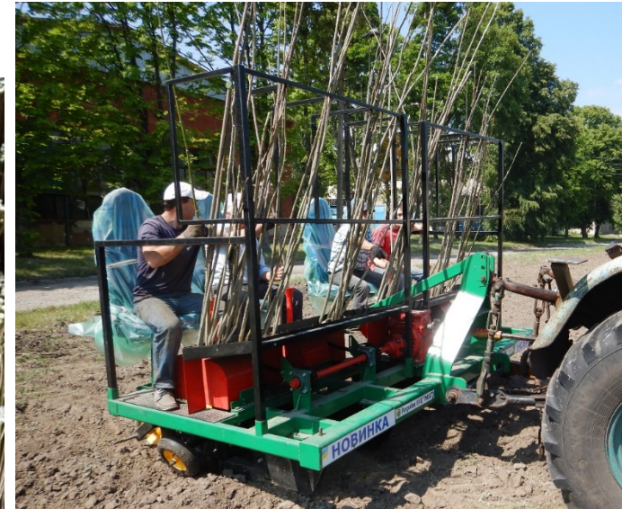
МС-4 «ВЕРБА», 4-рядна, Продуктивність: 1,1-1,5 га/год, ННЦ «ІМЕСГ», Відділ НТЗ виробництва біоенергетичних культур та овочів
