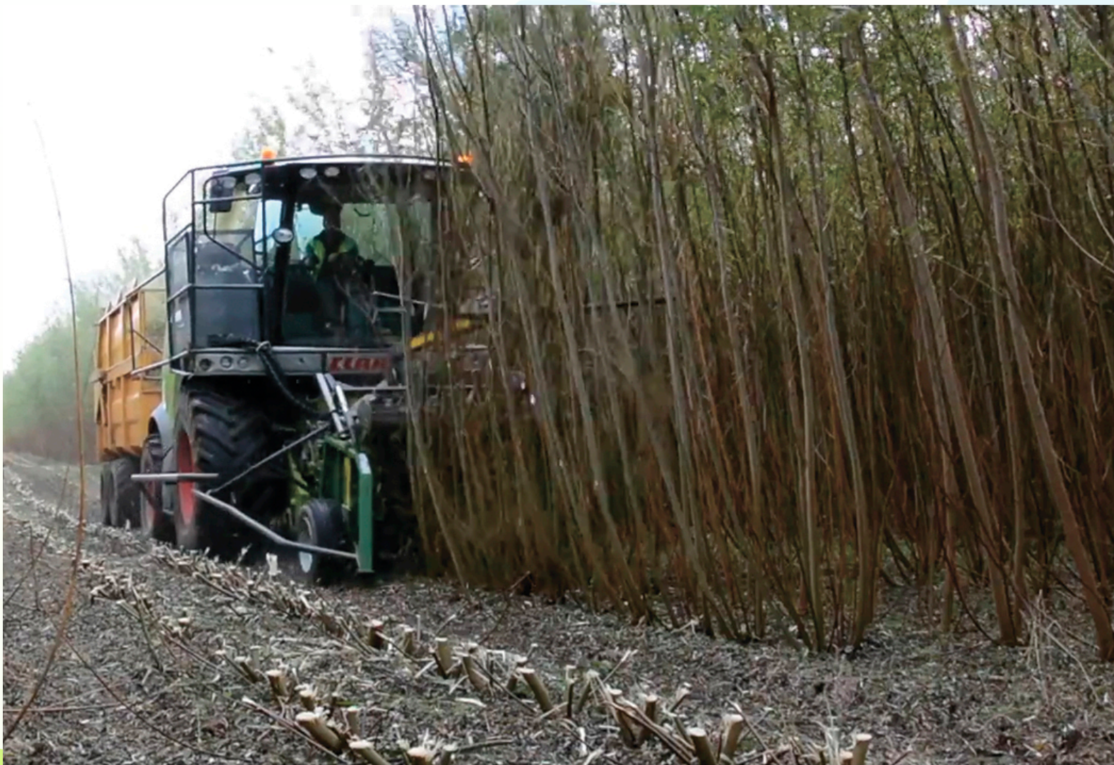
Механізоване скошування енергетичної верби
