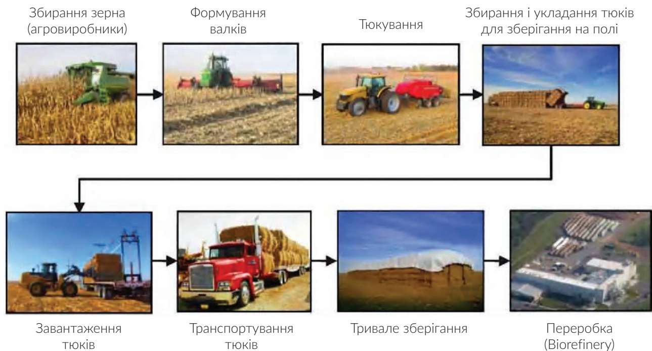
РИСУНОК 14: Схема ланцюга постачання кукурудзиння на завод із виробництва біоетанолу з лігноцелюлозної сировини DuPont 37 .
