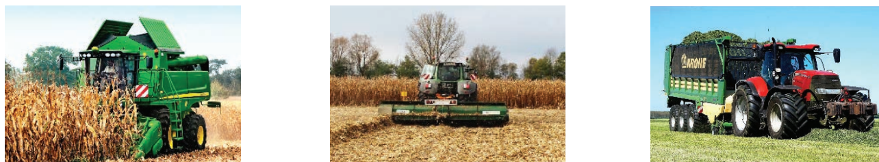
б) Система на базі кормозбирального причепа-підбирача: зернозбиральний комбайн + трактор з мульчувачем-валкоутворювачем + трактор з кормозбиральним причепом-підбирачем
