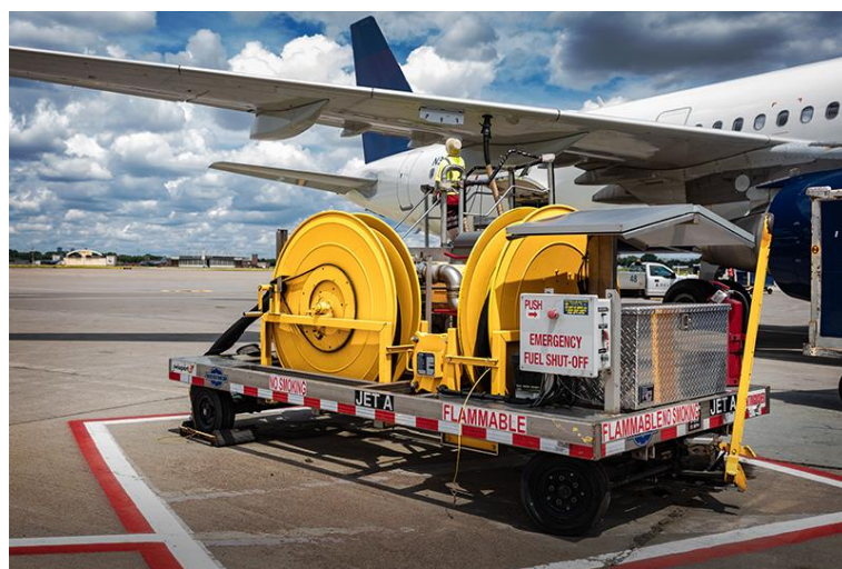
Рис. 2.8. Заправка літака з системи ЦЗЛ з використанням: а) гідранту на автомобільному шасі; б) гідранту на візку
