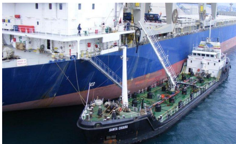
Рис. 2.17. Бункерування паливом з судна-бункерувальника [58].
