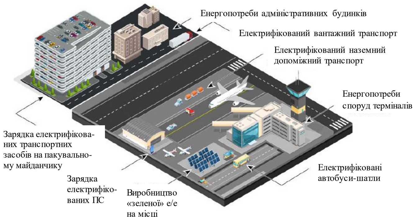
Рис. 1.20. Інтегрована схема енергопотреб аеропорту з електролітаками [26].
