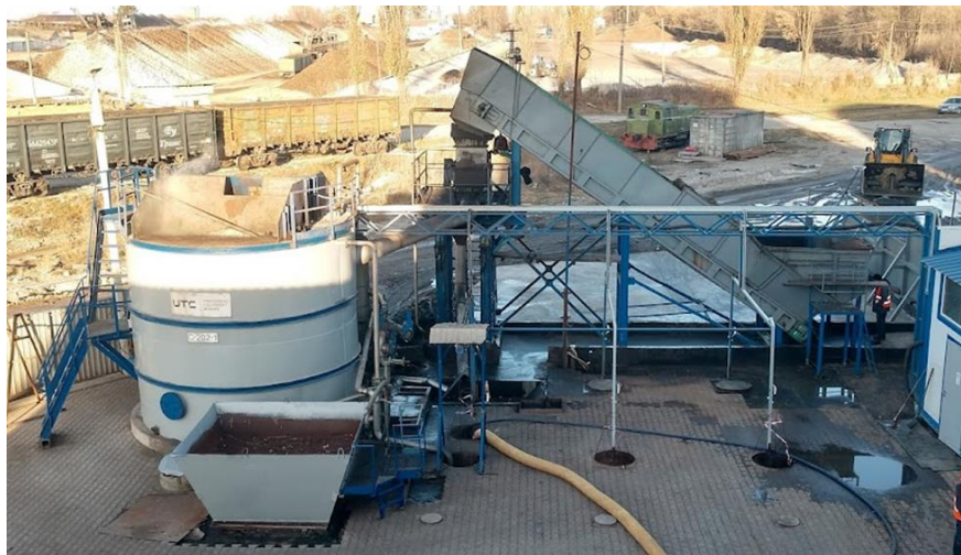
Система мокрого фрезерування, змішування та перекачування
