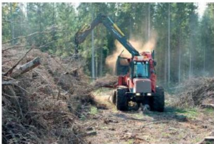
Виробництво деревної тріски з порубкових решток рубальною машиною, агрегованою з с/г трактором
