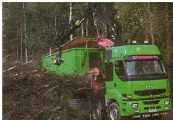
Виробництво деревної тріски з порубкових решток автотрісковозом, оснащеним рубальним модулем (комбінована машина)
