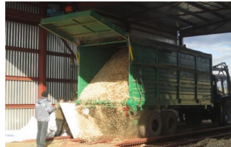
ТОВ «Камелія», 2014 рік – котельня на біомасі для опалення теплиць, 7 МВт. Встановлено 3 котли Крігер по 3,5 МВт. Паливо- тріска, пелети.
