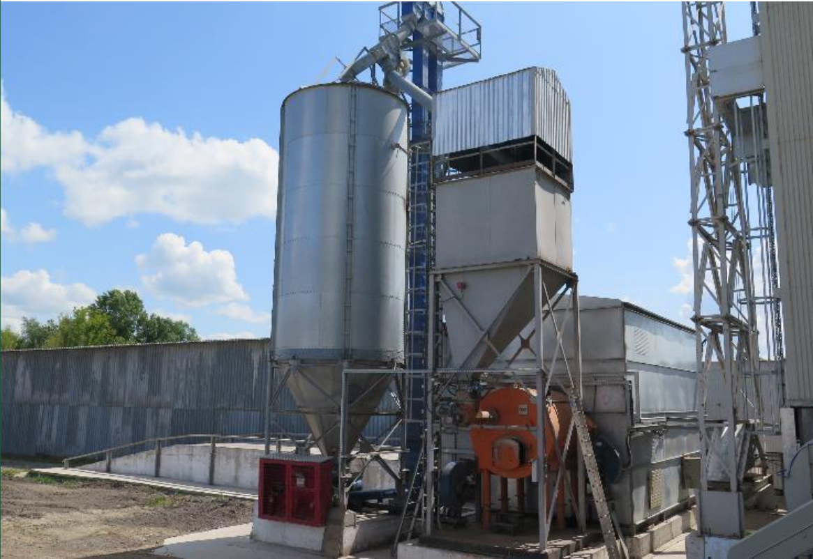
Теплогенератор компанії TEFF (м.Одеса) (6 МВт) до зерносушарки Vonfanti
