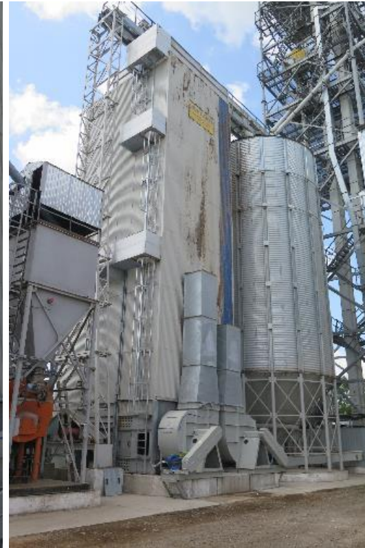
Теплогенератор компанії TEFF (м.Одеса) (6 МВт) до зерносушарки Vonfanti
