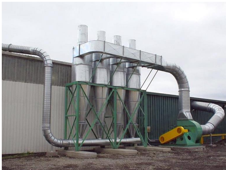
Циклони та мультициклони
