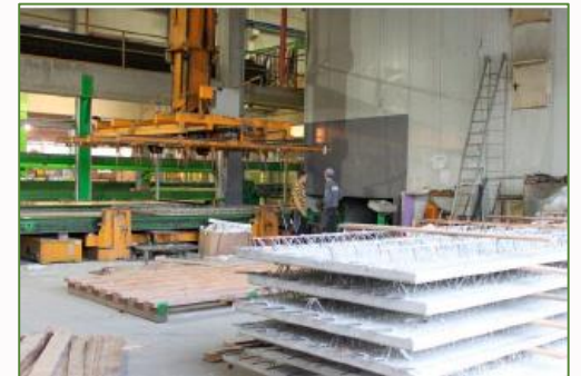
Збірні залізобетонні елементи щойно виймаються із сушильної камери
