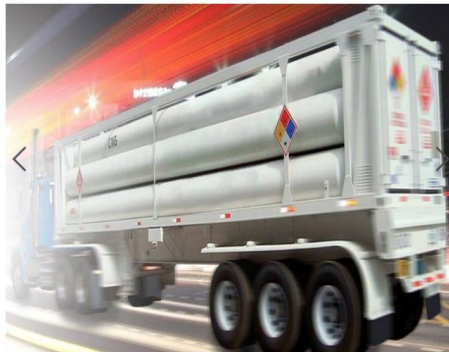
Контейнери для зберігання та транспортування стиснутого природного газу
