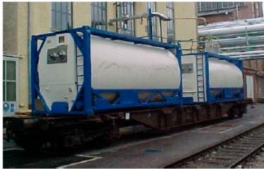
Залізничний вагон із системою накопичення тепла (TransHeat GmbH)
