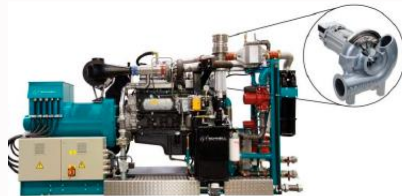
Двопаливний двигун з пілотним впорскуванням потужністю 235 кВт е з інтегрованою турбіною на вихлопних газах потужністю 30 кВт е (Schnell Motoren AG)
