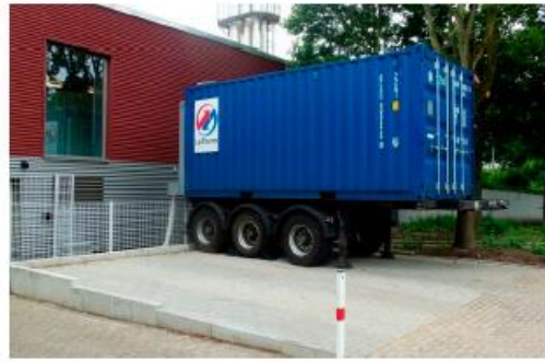
Причіп з контейнером і системою накопичення тепла (LaTherm GmbH)
