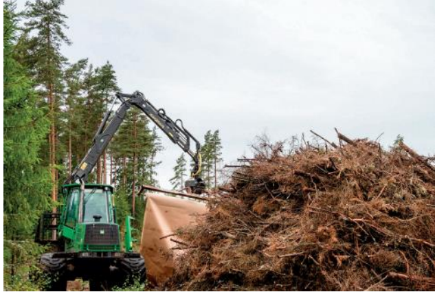
Складання порубкових залишок у купу форвардером
