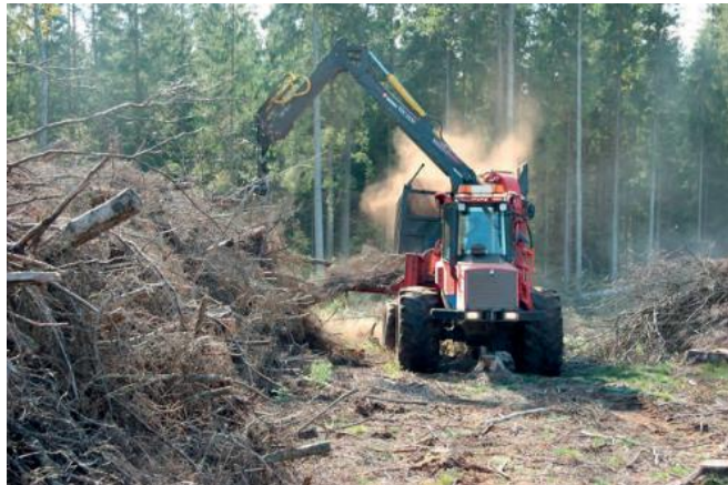
Виробництво деревних трісок рубальною машиною, агрегованою з с/г трактором
