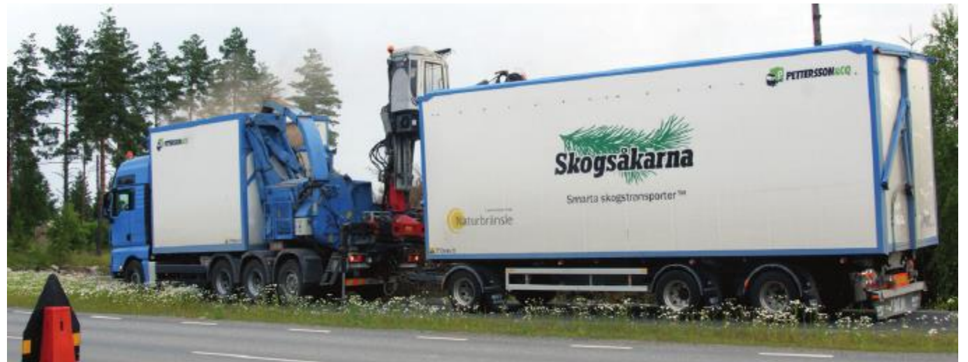
Виробництво деревних трісок автотрісковозом, оснащеним рубальним модулем
