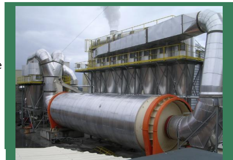
Сушарка тріски 18 т/год у Mortagua, Португалія вир-ва Recalor ( www.recalor.com )
