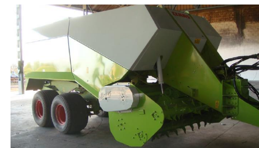
Подрібнювач SERRAT T2400 (Іспанія), встановлений на прес-підбирач соломи CLASS для підбирання та подрібнення обрізок дерев
