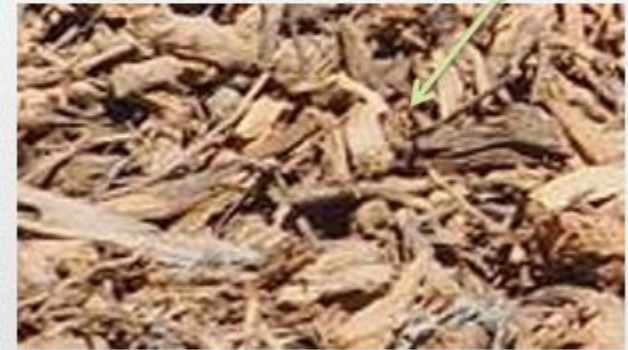
Деревина, подрібнена дробаркою (великі шматки, негомогенний матеріал)
