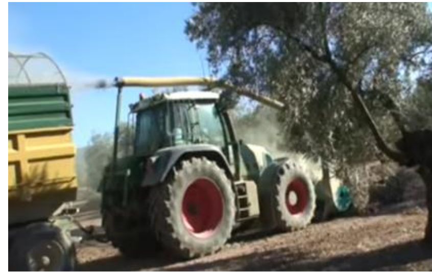
Biomasa Natura (PICURSA), Іспанія Трактор 100-180 к.с. Подрібнення молотками . Є сита. Економне енергоспоживання. https://www.picursa.com/en/machine/biomasa-mulcher-natura-frontal/#features-tab
