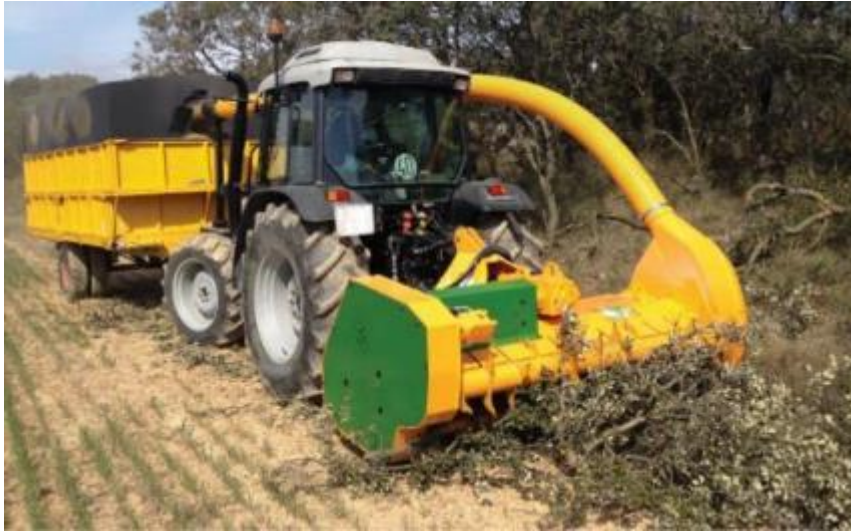
Biomass 150 (SERRAT), Іспанія Трактор 150 к.с. Подрібнення ротором . Подрібнює гілки діаметром до 8-10 см. Розмір подрібнення може налаштуватися https://www.serratmulchers.com/biomass150/
