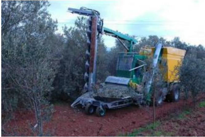
Модель Speedy cut (FAVARETTO, Італія) Подрібнення молотковою дробаркою https://www.mdpi.com/1996-1073/13/6/1359
