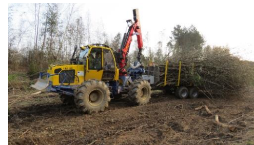
Форвардери - самозавантажувальні машини для трелювання сортиментів або відходів рубки
