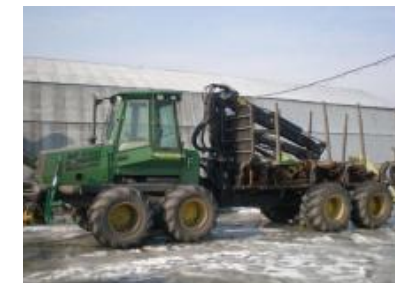
Форвардери - самозавантажувальні машини для трелювання сортиментів або відходів рубки
