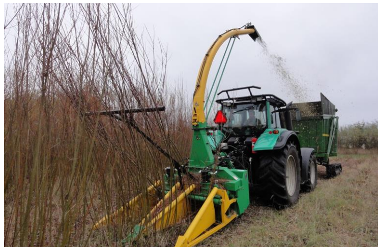
Навісний харвестер JF Energy Harvester
