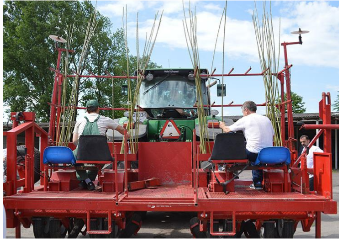
Egedal Energy Planter, 4-рядна, Продуктивність: 1,5-3 га/год , Egedal Maskinfabrik A/S, http://www.egedal.dk
