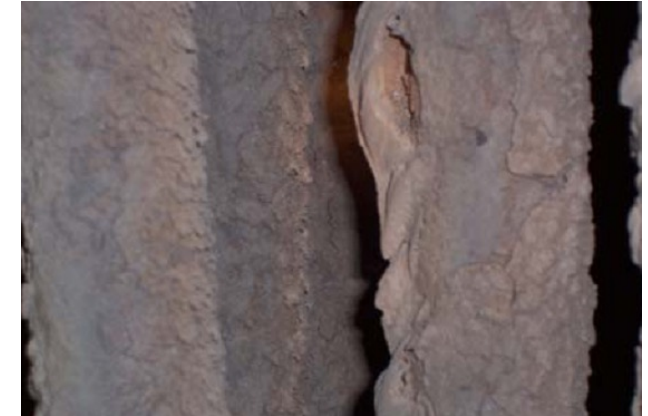
Відкладення на конвективних поверхнях
