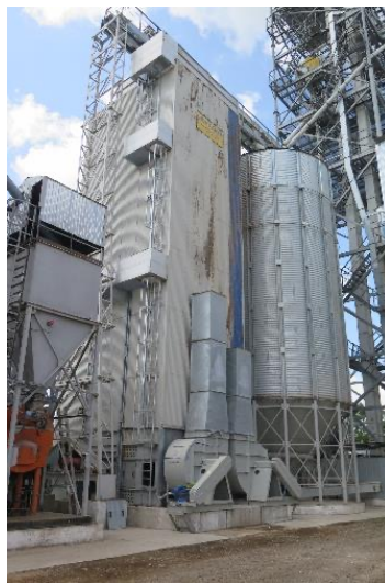
Теплогенератор компанії TEFF (м.Одеса) (6 МВт) до зерносушарки Bonfanti
