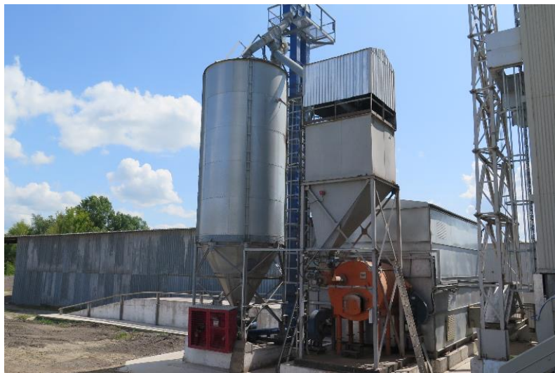
Теплогенератор компанії TEFF (м.Одеса) (6 МВт) до зерносушарки Bonfanti
