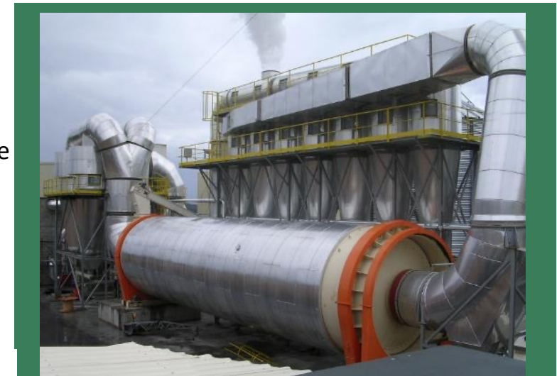
Сушарка тріски 18 т/год у Mortagua, Португалія вир-ва Recalor ( www.recalor.com )
