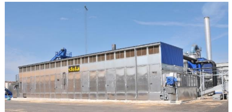
Стрічкова сушарка BT 1-6200-30 у Латвії для тріска продуктивністю 8,5 т/год з 50% до 10%
