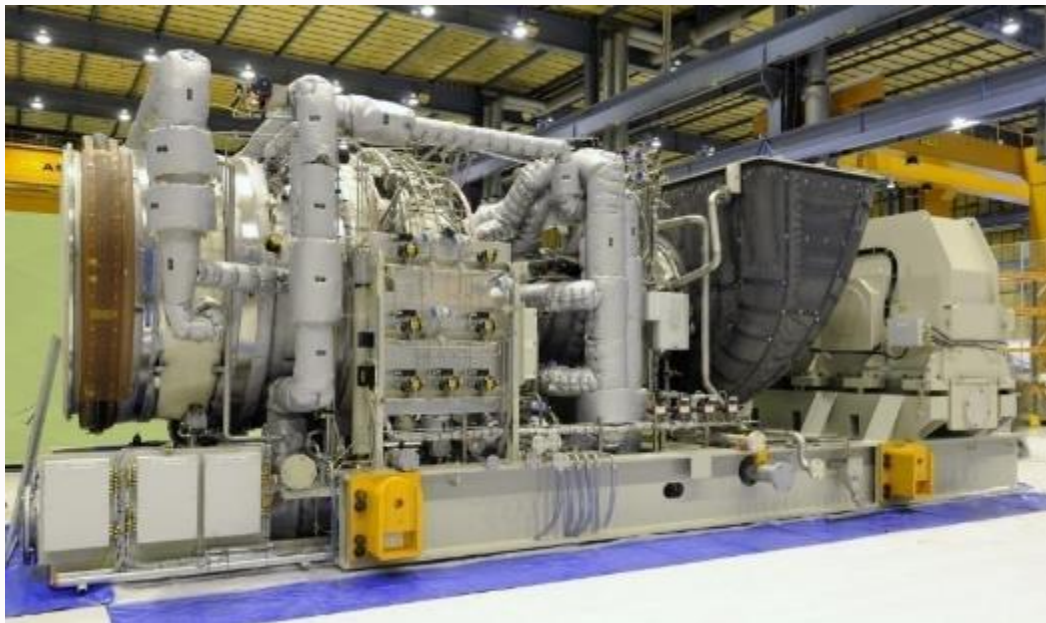
Газова турбіна SGT-800 виробництва Siemens потужністю 47 МВт
