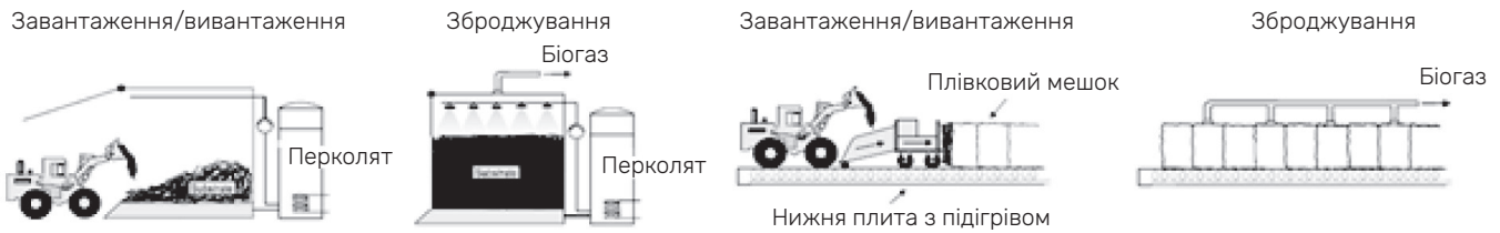
Рис. 6.3 – Приклади технологій періодичного анаеробного зброджування а) – схема з перколят-реактором; б) схема з тунельним реактором
