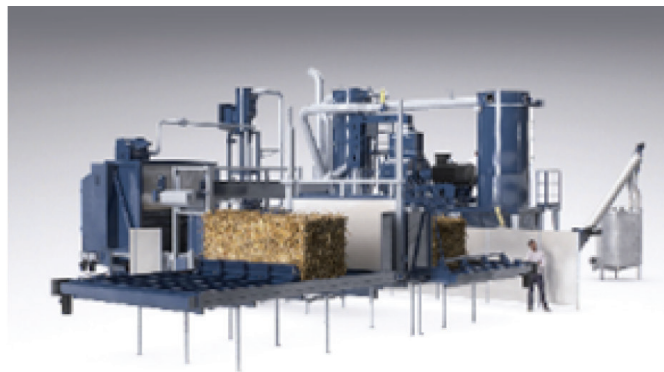
Рис. 9.9 – Біогазова установка в м. Kværs: загальний вигляд (ліворуч) та лінія попередньої обробки соломи LinKa (праворуч)
