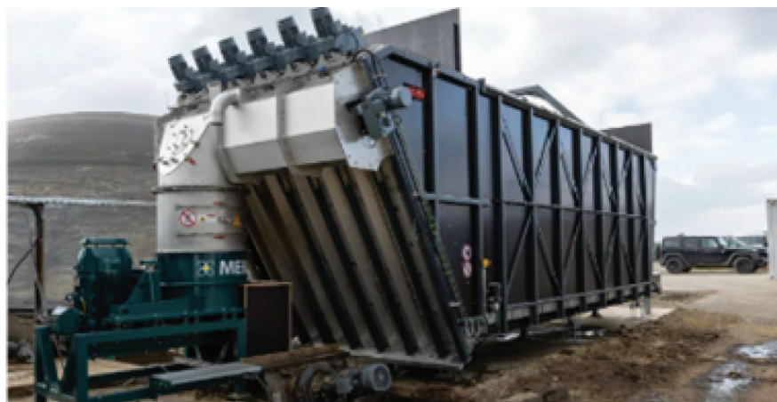
Рис. 5.3 – Подрібнювач Biogringer та його компоновка з системою подачі сировини
