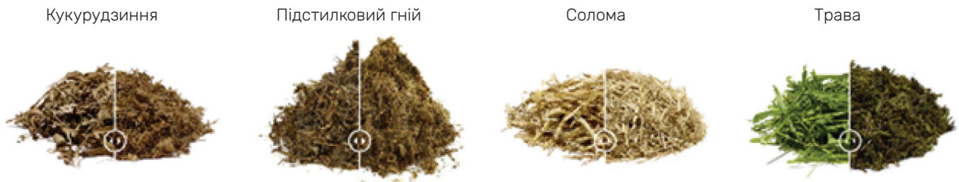
Рис. 5.5 – Деякі види сировини до та після подрібненні в обладнанні BIOCRUSHER
