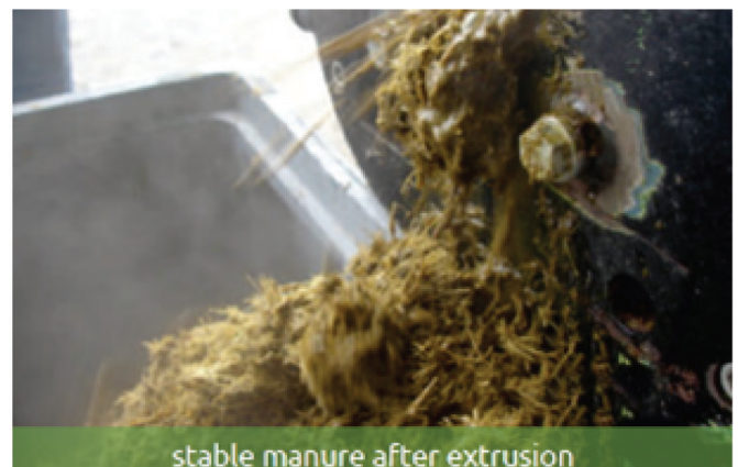
Рис. 5.8 – Підстилковий гній ВРХ до обробки і після обробки в біоекструдері
