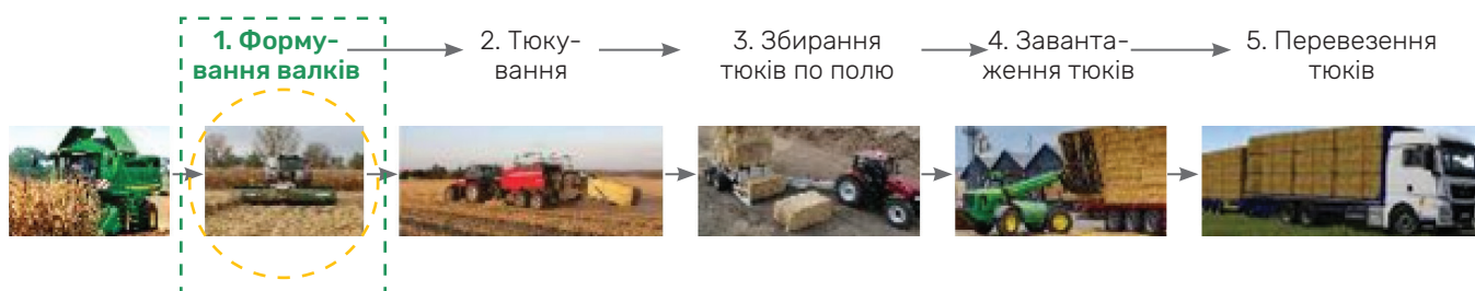
Рис. 4.5 – Технологічна схема заготівлі кукурудзиння у великих прямокутних тюках
