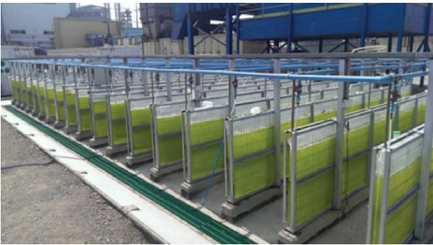
Рис. 2.4 – Пілотна система плоскопанельного фотобіореактора (1,5 м висота, 10 м завдовжки, 0,10 м завширшки), розташована в Токопільї, Чилі, на території теплоелектростанції Е-CL 71
