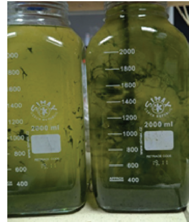
Рис. 2.8 – Хімічна флокуляція в лабораторних умовах з використанням хітозану (Фото авторів АЗ)
