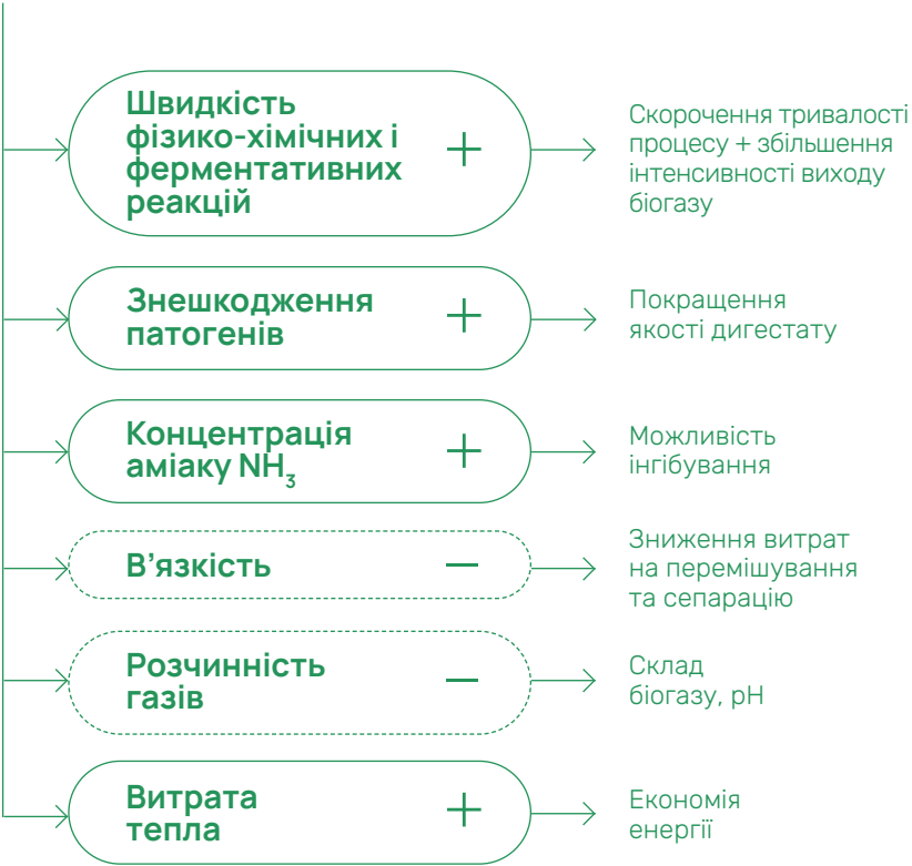
Рис. 8. Вплив температури на різні аспекти технології виробництва біогазу
