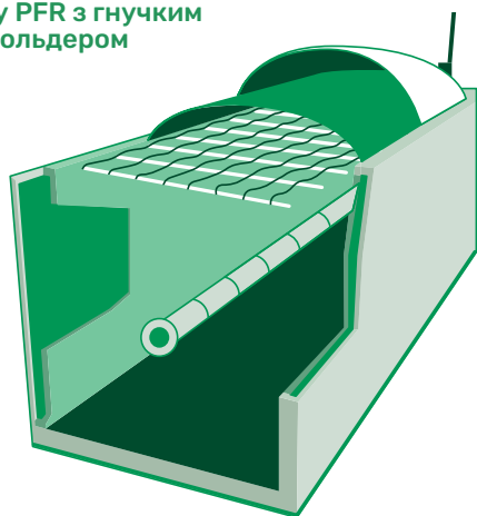
Рис. 12. Горизонтальний біореактор типу PFR з гнучким газгольдером
